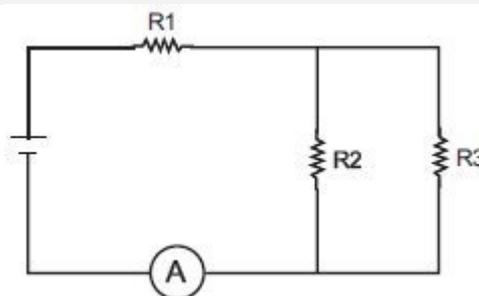
No circuito apresentado na figura acima, onde  $V = 12 \text{ V}$ ,  $R1 = 5 \Omega$ ,  $R2 = 2 \Omega$ ,  $R3 = 2 \Omega$ , podemos dizer que a corrente medida pelo amperímetro A, colocado no circuito é:
